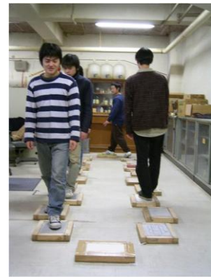
写真2. 歩行実験状況
