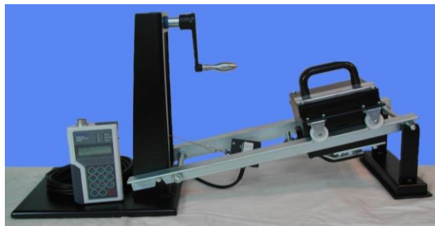
写真 1. 携帯型床のすべり試験機 (ONO・PPSM)
