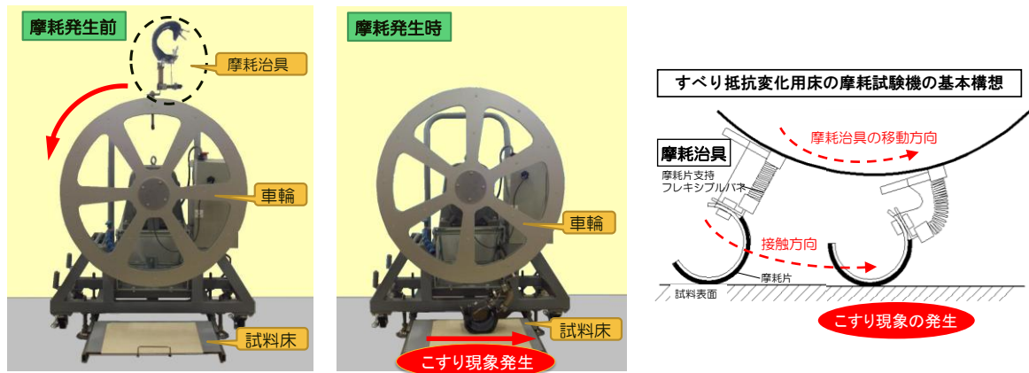
写真4. 開発したすべり抵抗変化用床の摩耗試験機と基本構想
