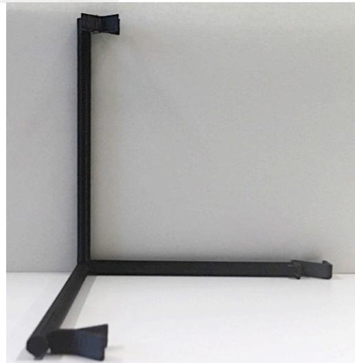
の部分は宙に浮いているような状態になっているが、ここは最初に支えの部分が作られて、その上に「X」を積み上げていくことによって作られる。完成後には土台と共にその支えを取り除くので、このような形が実現できるのである。最初に出力された2本の軸は比較的短い時間で出来上がったのだが、残りの一つに関しては小さな円形に樹脂を絞り出し、それをどんどん上に積み上げていく必要があるため、作業が細かくなり、想像以上に作成に時間がかかった。
