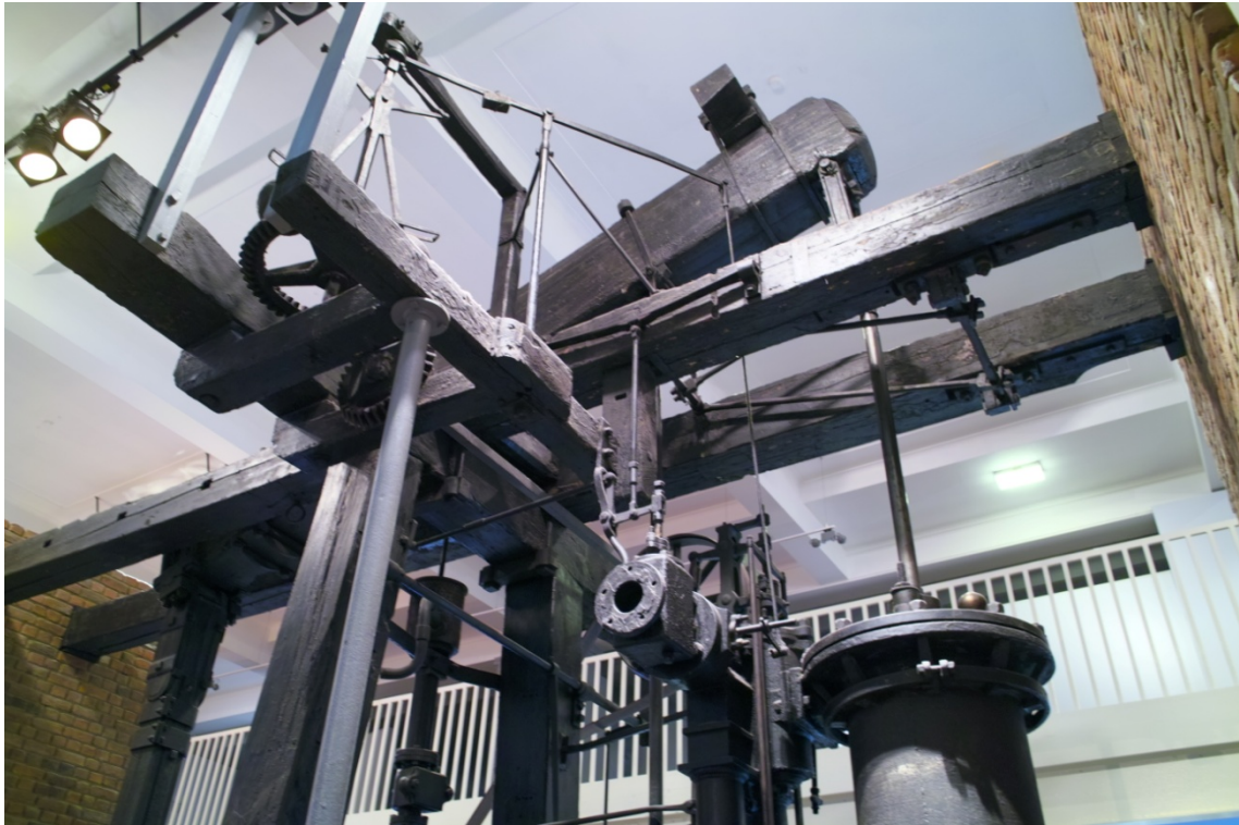
図 1-4 Science Museum (London) の Energy Hall(1 階)の蒸気機関 (2010 年 12 月, 筆者撮影) 支柱や梁が木製であることに注目。
